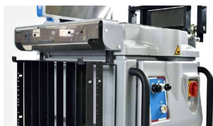
本体片側または両側に 最大3枚ずつ成形グリッドを 収納できるフック付き
