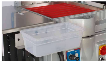
上ぶた付きの着脱式打ち粉トレイ 機械の4か所に取り付け可能
